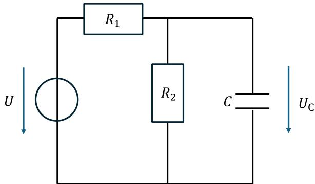
Nous souhaitons déterminer l'évolution de la tension aux bornes du condensateur.
